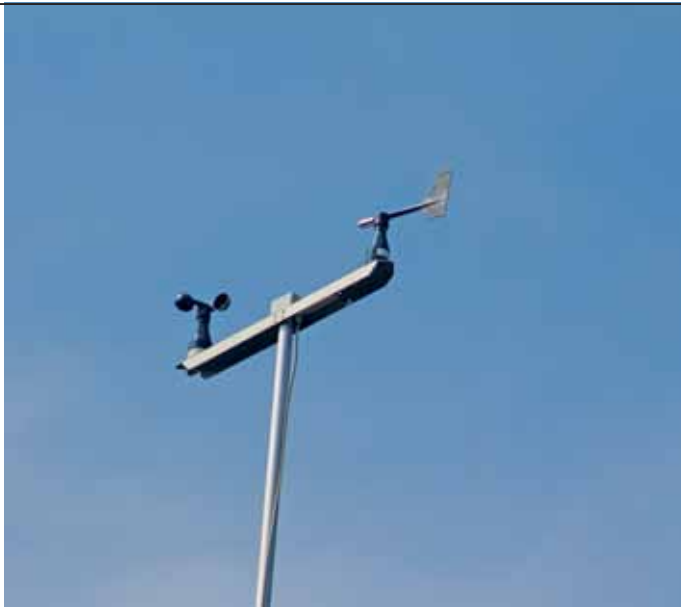
Geschwindigkeits- und Richtungsmesser an der Messstation Speed and direction gauge at the measurement station
