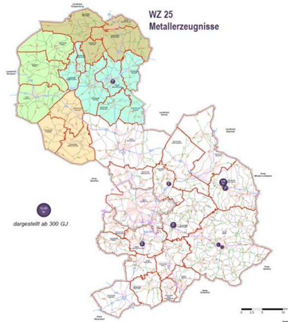
Abbildung 36: Standorte der Branche Metallerzeugnisse (WZ25) ab ca. 300 GJ/a Abwärmepotenzial
