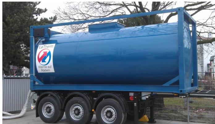
Abbildung 13: Thermochemischer Speicher der Firma LaTherm, Bild: (La Therm Energie AG 2014)
